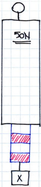
Şekildeki dinamometre 10 eşit bölmeden oluşup, 50N'a kadar ölçüm yapmaktadır. Buna göre X'in ağırlığı?
